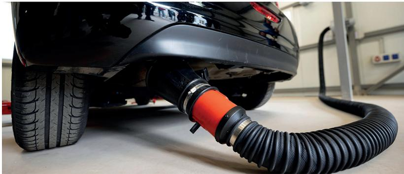
**Fig. 7.** *Medición de emisiones diésel en un automóvil. (Fuente: Hella Tech World)*
