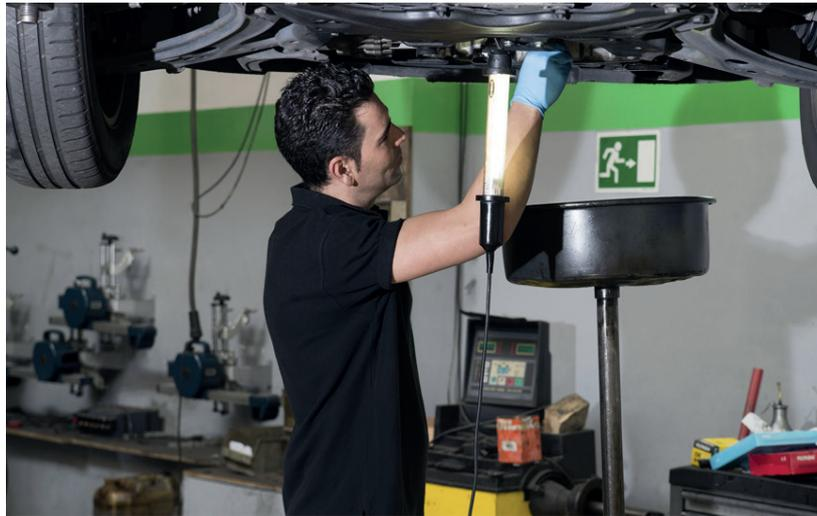
**Fig. 8.** Mecánico efectuando un cambio de aceite en un automóvil (Fuente: Talleres Base 2)
