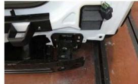
En impactos de baja o media intensidad, hasta 16 Km/h contra un objeto rígido, dependiendo del modelo de vehículo, pueden ser capaces de absorber toda la energía sin transmitir ninguna deformación al larguero o al faldón.
