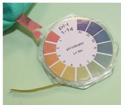
*El papel indicador se ha sumergido en electrolito de una batería de plomo/ácido al compararse el color en la escala el pH es muy próximo a 1, es muy ácido lo contrario a alcalino.*
