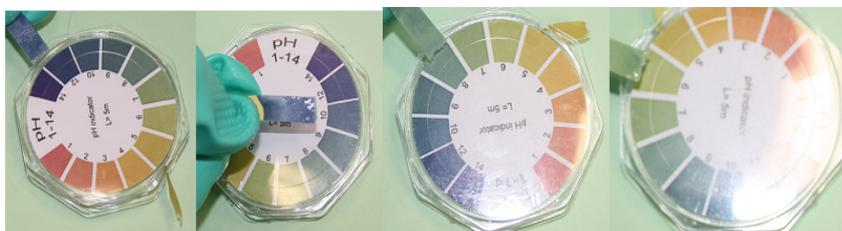
*La secuencia muestra el proceso de neutralización del electrolito de una batería de níquel/hidruro metálico con la adición de cantidades progresivas de disolución de ácido bórico, el pH va descendiendo, cuando se alcanza el valor de pH = 7 el electrolito está neutralizado.*
