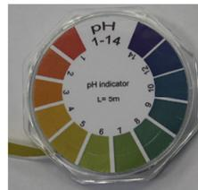
*Papel indicador de pH, el valor del pH se determina comparando el color que toma este al ponerse en contacto con el líquido que se está testeando*
