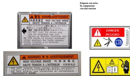
Indicación de riesgo eléctrico en un componente, tapa del inversor de un Toyota Prius
