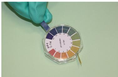
*Se ha mojado el papel indicador en electrolito de una batería de níquel/hidruro metálico, el color que toma el papel al compararse con la escala de color indica un valor del pH comprendido muy próximo a 14, es un pH muy alcalino.*
