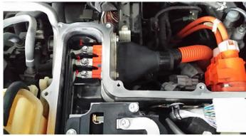
Los terminales 1, 2, 3 corresponden a las fases de las maquinas electricas a de medirse la tension entre ellas que ha de ser 0V y entre ellas y la carcasa del inversor/ondulador que también ha de ser 0V.
